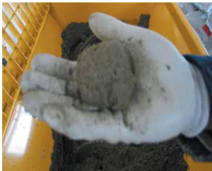
Verifica della consistenza "terra umida" dell'impasto.
