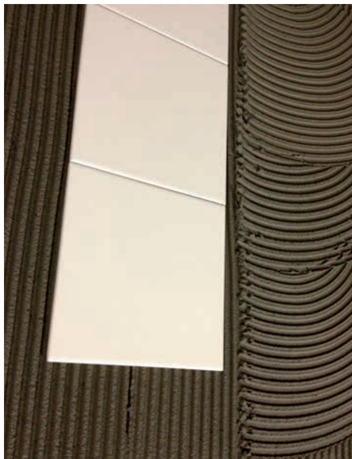
Le prove eseguite su LACOLLA hanno dato come risultato uno scivolamento in verticale praticamente nullo (cioè < 0,5 mm).
